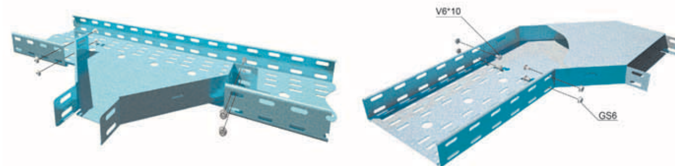
Схемы монтажа аксессуаров для разветвления кабельной трассы
